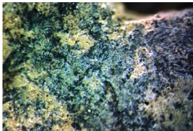
Ryc. 6. Struktury mikroporowate charakterystyczne dla smół drzewnych – efekt wydzielania gazów i par lotnych substancji w trakcie powstawania smoły (próbka Sr 910) pod wpływem wysokiej temperatury (polaryzacyjny mikroskop optyczny PZO, powiększenie 240 x)
